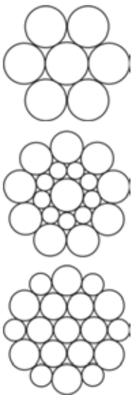
Поперечное сечение каната диаметром 13/15/18мм
